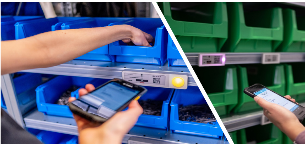
Abbildung 1: E-Paper-basiertes Pick-by-Light mit WMS-Anbin- dung im Picking Lab (Bildquelle: Fraunhofer IML)
