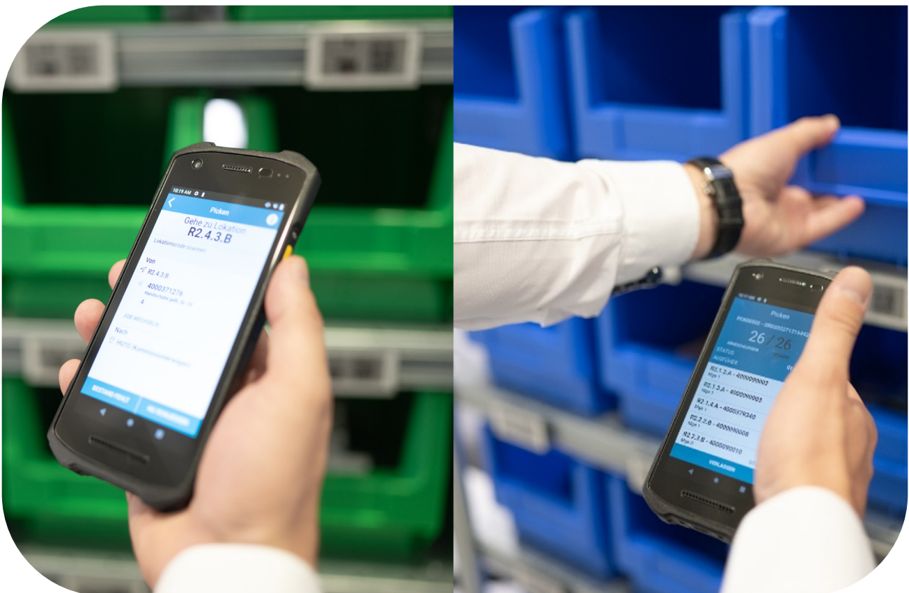
Abbildung 5: Pick-by-Light mit WMS-Kommissionierführung auf einem MDE-Gerät (Bildquelle: Fraunhofer IML)
